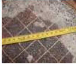
סתימה של משטח הכניסה ← לנקות מסנן פגום בעזרת שאיבה, היווצרות של סולפט?
