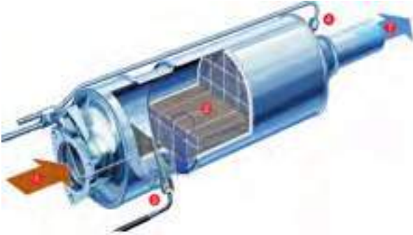
מסנן חלקיקים DPF מבודד בתוך מעטפת פלדה, מחובר במעלה הזרם באמצעות DOC וסנסורים בקרה PSA 2000
