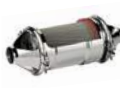
System z adytywem FBC, oraz z elektryczną aktywacją regeneracji
