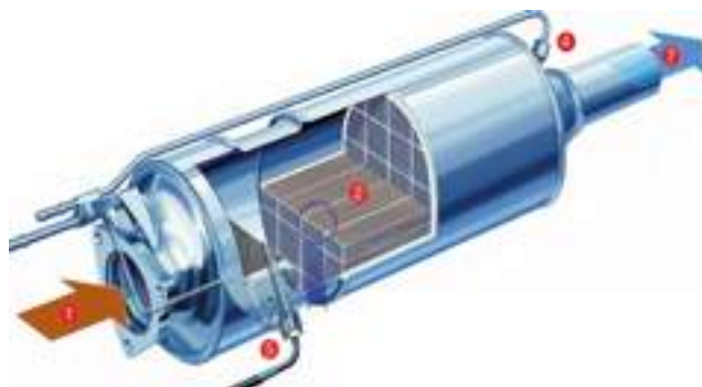
Filtr cząstek stałych w stalowej obudowie izolacyjnej, z reaktorem utleniającym i czujnikami; PSA 2000
