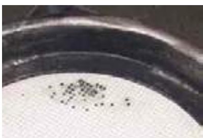
Kleine innere Risse zeigen sich in einzelnen schwarzen Zellen auf der Austrittsseite, die mit Keramikpaste verschlossen werden können.
