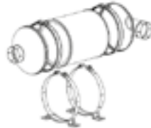
Fixierung am Fahrzeug bei hohen Vibrationen
