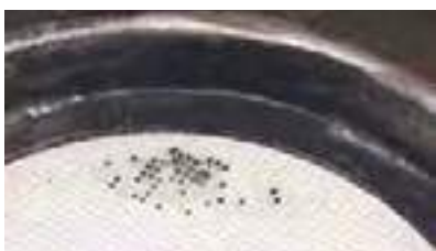
Des cellules noires sur la surface de sortie du filtre indiquent clairement la présence de petites fissures internes
